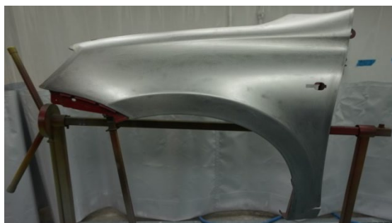
Установка переднего крыла
